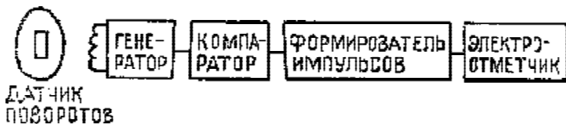
Рис. 12. Блок схема установки для изучения поворотов и перемещений яиц в гнездах птиц
