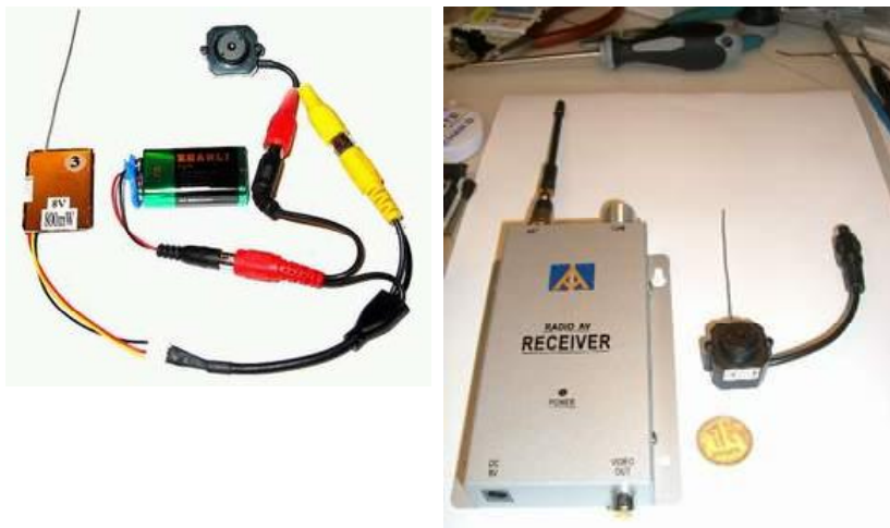
Рис. 9. Внешний вид микровидеокамеры ZT802 с передатчиком и приемником телевизионного канала
