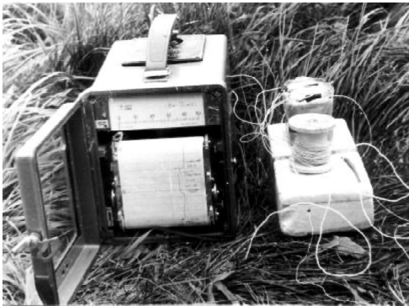
Рис. 2. Внешний вид установки для измерения температуры поверхности яиц и внутрияйцевой температуры в гнездах птиц
