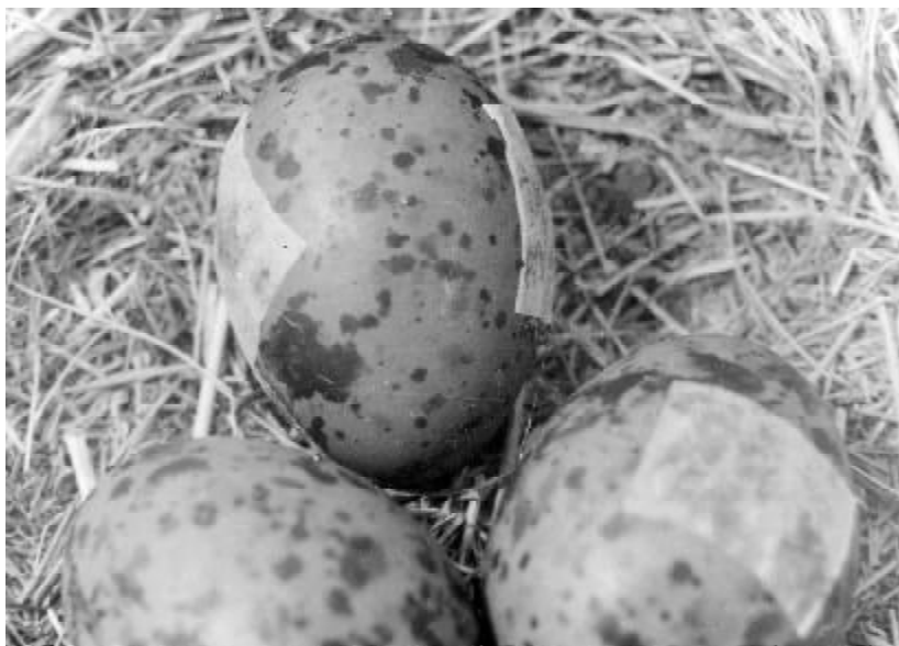
Рис. 5. Термопары, наклеенные на яйцо сизой чайки
