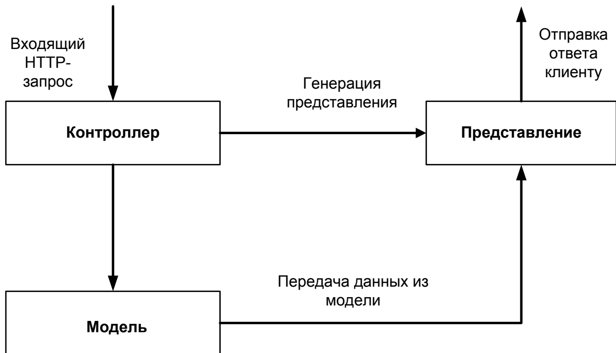
Рис. 1 Взаимодействие между контроллером, моделью и представлением
